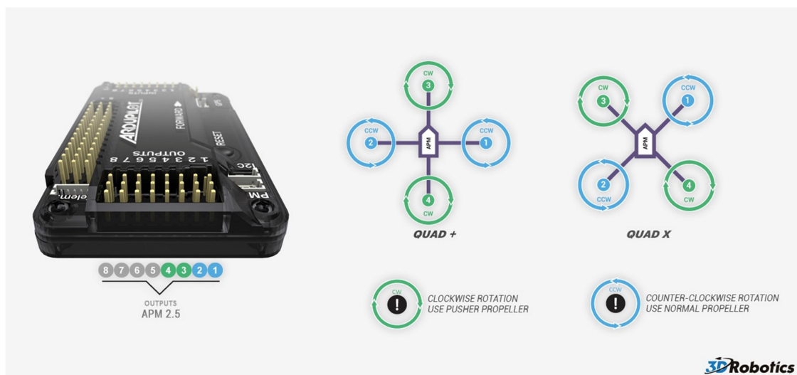
Figura 21: Conexiones entre reguladores y APM en función de la configuración de vuelo
