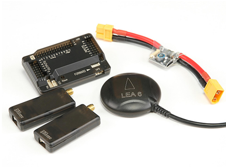
Figura 7: Placa, módulos de telemetría, GPS y sensor de corriente
